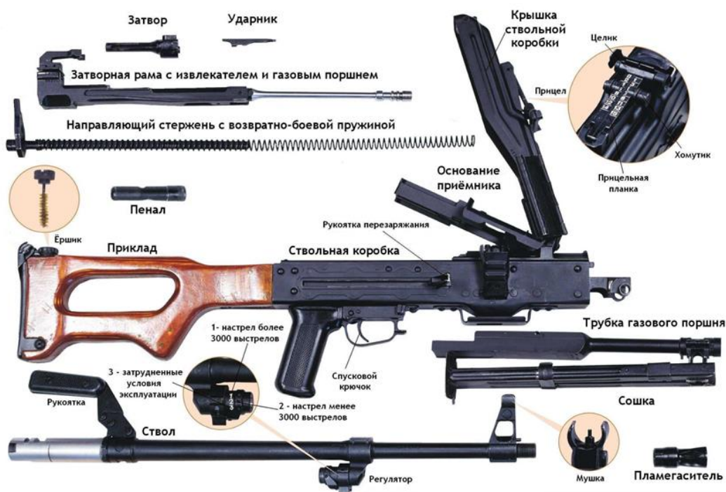
Рис.87 Основные части и механизмы пулемета ПКМ.
