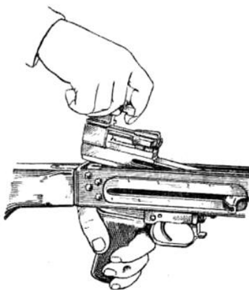
Рис. 91 Отделение затворной рамы с затвором
