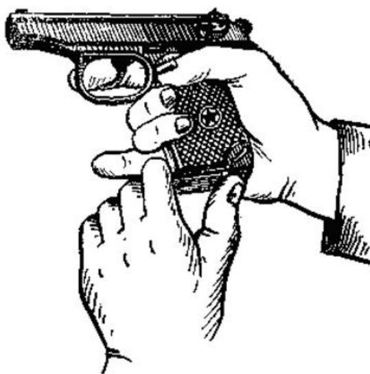
Рис. 61 Извлечение магазина из основания рукоятки
