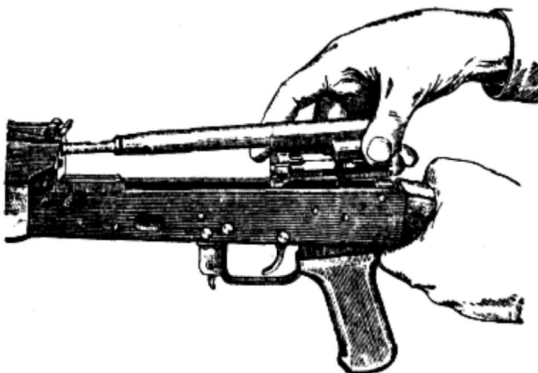
Рис. 27. Отделение затворной рамы с затвором
