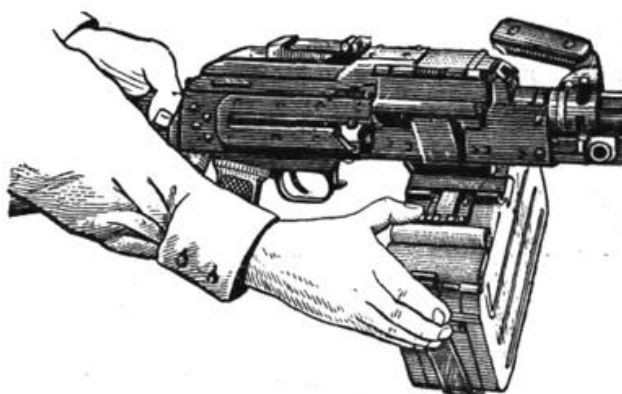
Рис. 88 Отделение коробки с лентой от пулемета
