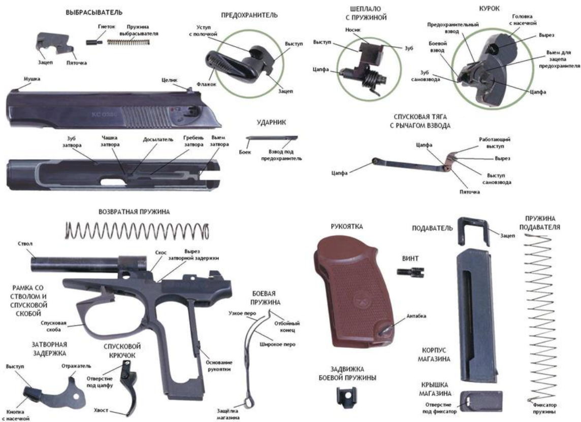
Рис. 52 Основные части и механизмы пистолета ПМ 9-мм патроны
