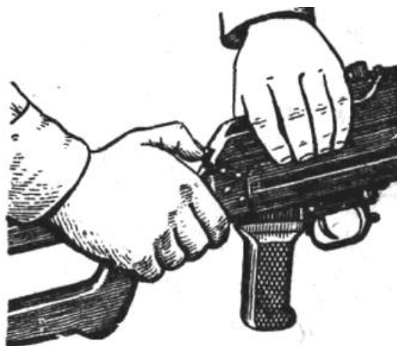
Рис. 89 Открывание крышки ствольной коробки
