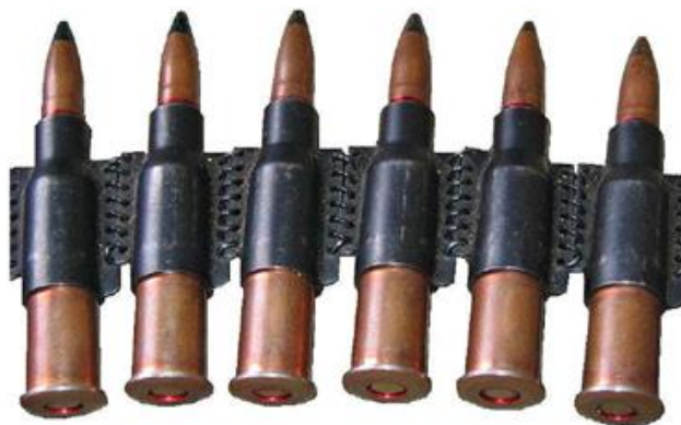
Рис. 97 Фрагмент пулемётной ленты
