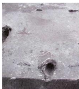
Рис 105 Броня современного танка, пробитая кумулятивными гранатами
