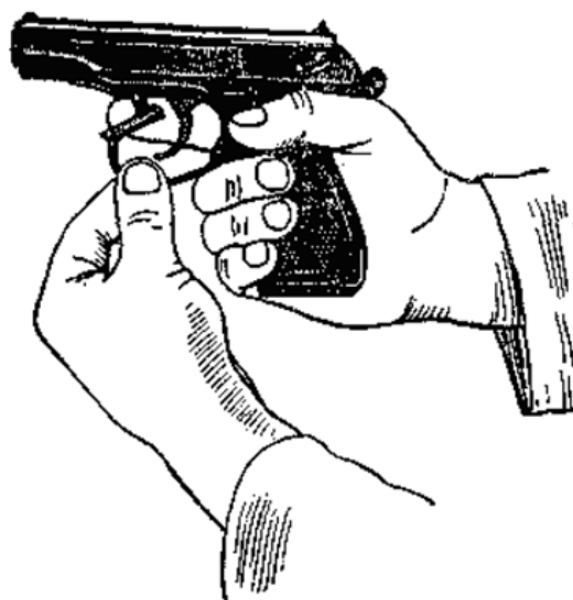
Рис. 61 Оттягивание спусковой скобы
