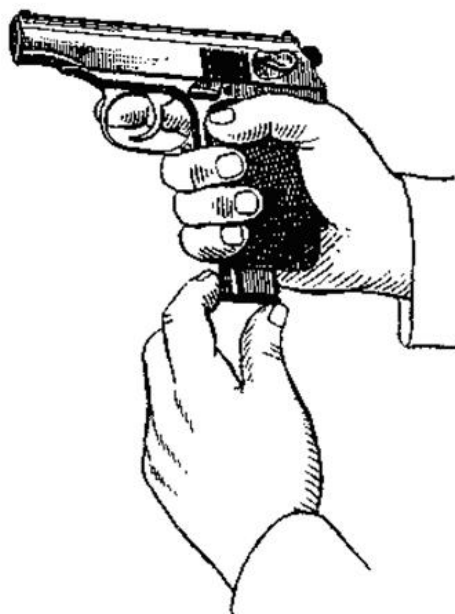
Рис. 65 Вставление магазина в основание рукоятки
