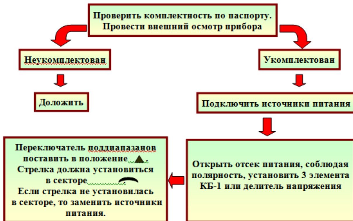
Рис. 3.3. Алгоритм подготовки прибора ДП-5В к работе
