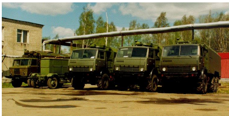
Рис. 6.5. Подвижная химическая лаборатория АЛ-5
