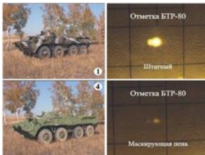
Рис. 6.11. Применение радиопоглощающих пен
