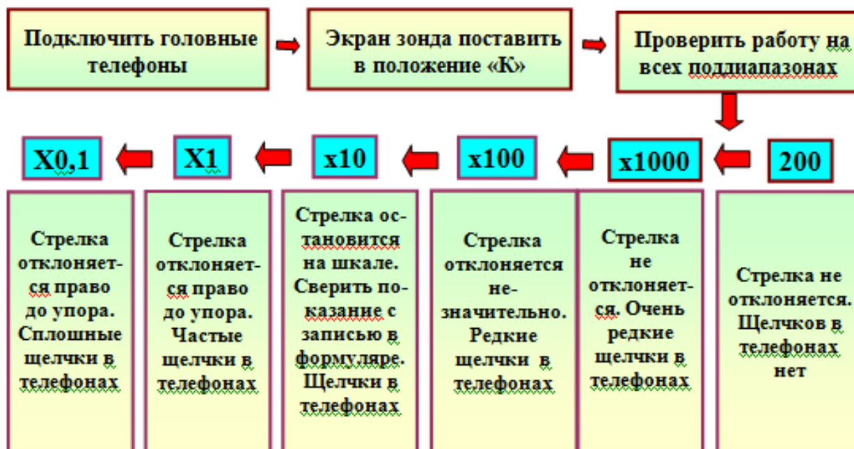
Рис. 3.4. Алгоритм проверки работоспособности ДП-5В
