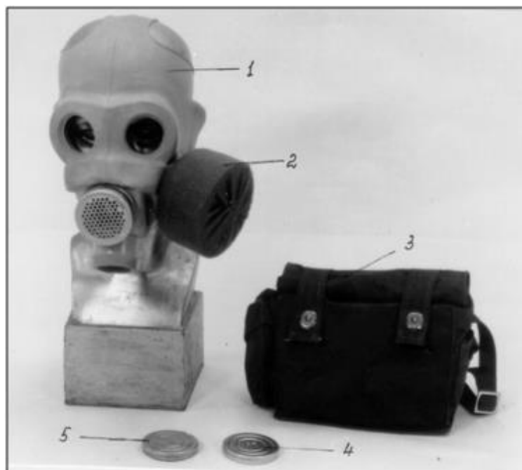
Рис. 2.1. Противогаз ПМГ: 1 - шлем-маска ШМГ; 2 - фильтрующе-поглощающая коробка ЕО-18К в чехле; 3 - сумка; 4 - незапотевающие пленки; 5 - мембраны переговорного устройства
