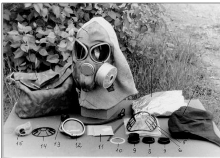
Рис. 2.5. Противогаз ПМК-3 : 1 - сумка; 2 - противогаз ПМК-3 с капюшоном; 3 - респиратор РОУ в упаковочном пакете; 4 - утеплитель; 5 - вкладыш; 6 - мешок водонепроницаемый; 7 - заглушка; 8 - обтекатель; 9 - переходник; 10 - кольцо резиновое; 11 - ПСЗГ; 12 - НМУ; 13 – присоединительное устройство приспособления для приема воды; 14 - решетка; 15 - чехол
