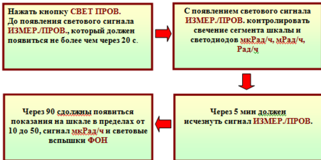
Рис. 3.11. Алгоритм проверки работоспособности ИМД-2
