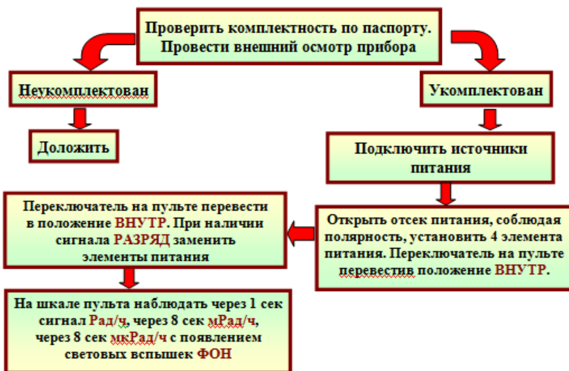
Рис. 3.10. Алгоритм подготовки ИМД-2 к работе
