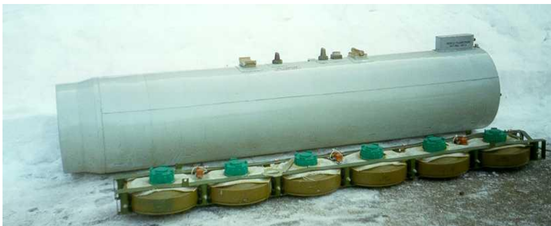
Рис. 5.6. Вертолетный минный раскладчик ВМР-1 с УДШ
