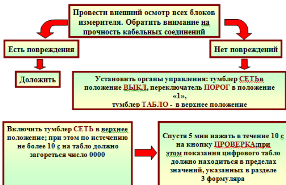
Рис. 3.6. Алгоритм подготовка к работе и проверка работоспособности ИМД-21
